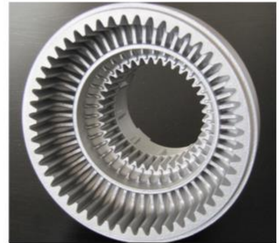
Växelhus i aluminium tillverkad genom 3D-printing
